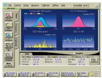
Figure 9. Inter-Symbol Interference
