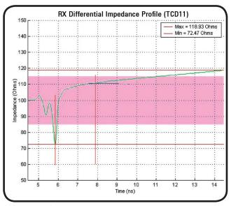
Figure 14. Tx/Rx Impedance
